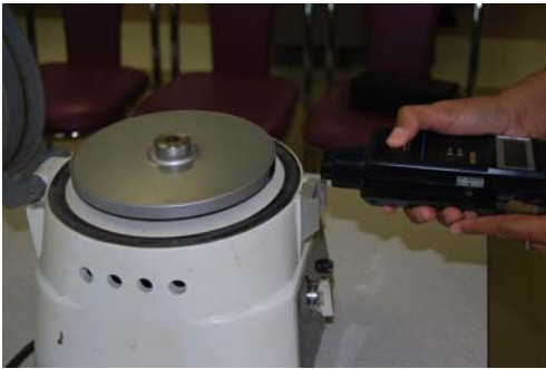
รูปที่ 5.15 แสดงการใช้ Digital Tachometer วัดค่าความเร็วรอบ
