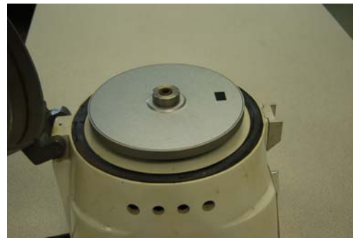
รูปที่ 5.14 แสดงการติดตั้งเกอ์สะท้อนแสงบนจาน
