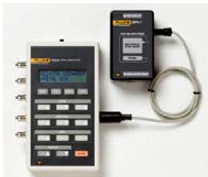
รูปที่ 4.3 แสดงเครื่องมาตรฐานสอบเทียบ และอุปกรณ์ประกอบการสอบเทียบ
