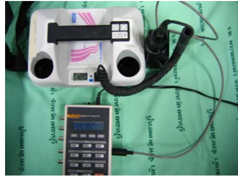
รูปที่ 4.5 วิธีการต่อเครื่องสอบเทียบแบบใช้หัวโพรบ
