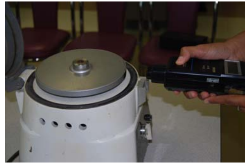
รูปที่ 5.15 แสดงการใช้ Digital Tachometer วัดค่าความเร็วรอบ
