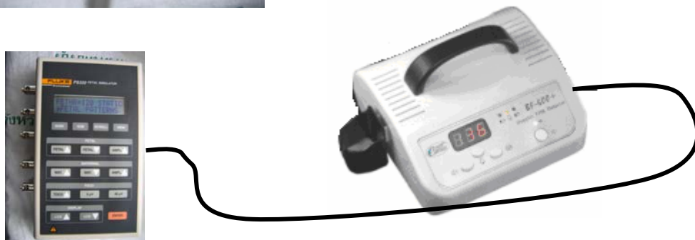
รูปที่ 4.4 วิธีการต่อเครื่องสอบเทียบแบบโดยไม่ใช้หัวโพรบ
