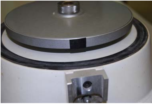
รูปที่ 5.14 แสดงการติดตั้งเกอ์สะท้อนแสงบนจาน
