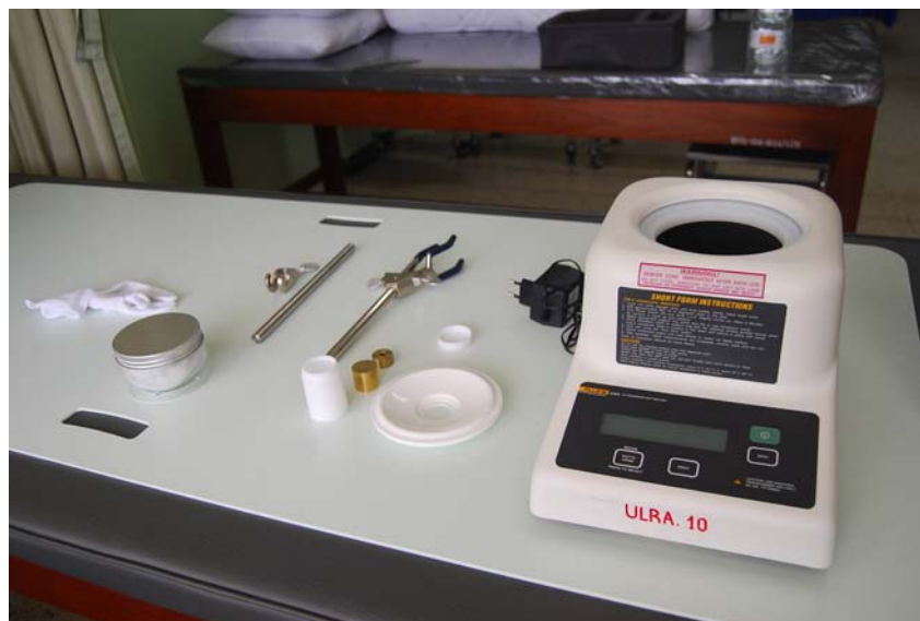
รูปที่ 13.9 แสดงเครื่องมาตรฐานสอบเทียบ และอุปกรณ์ประกอบการสอบเทียบ
