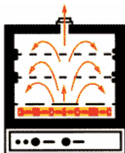
การให้ความร้อนของ Gravity convection oven
