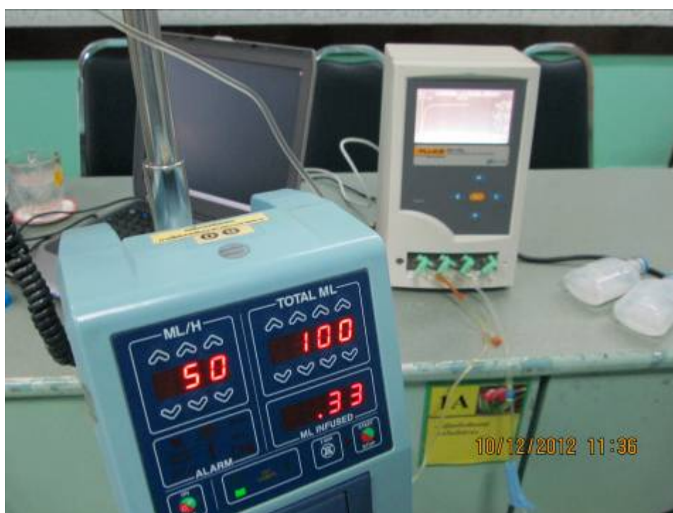
รูปที่ ๒๓ แสดงภาพขณะเครื่องวัดกำลังวิเคราะห์ผลจากชุด IV SET
