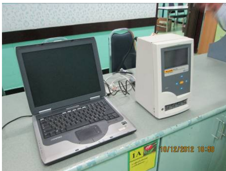
รูปที่ ๑๙ เครื่อง Infusion Pump Analyzer รุ่น IDA-4 Plus และอุปกรณ์สำหรับวิเคราะห์ผล
