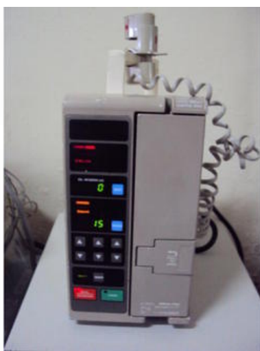
รูปที่ ๓๓ แสดงภาพเครื่อง Infusion Pump ยี่ห้อ NIKKISO รุ่น PFA-06
