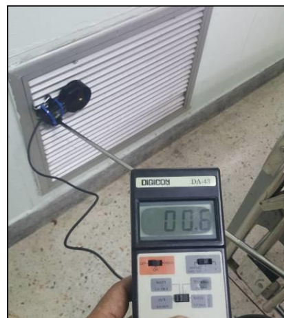
ภาพตัวอย่างการวัดความเร็วลมที่ช่องระบายอากาศ
