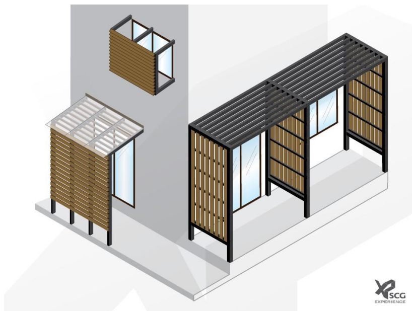
ภาพ: แสดงแผงบังแดด ระแนงกันแดด เพื่อป้องกันผนังจากแสงแดด
